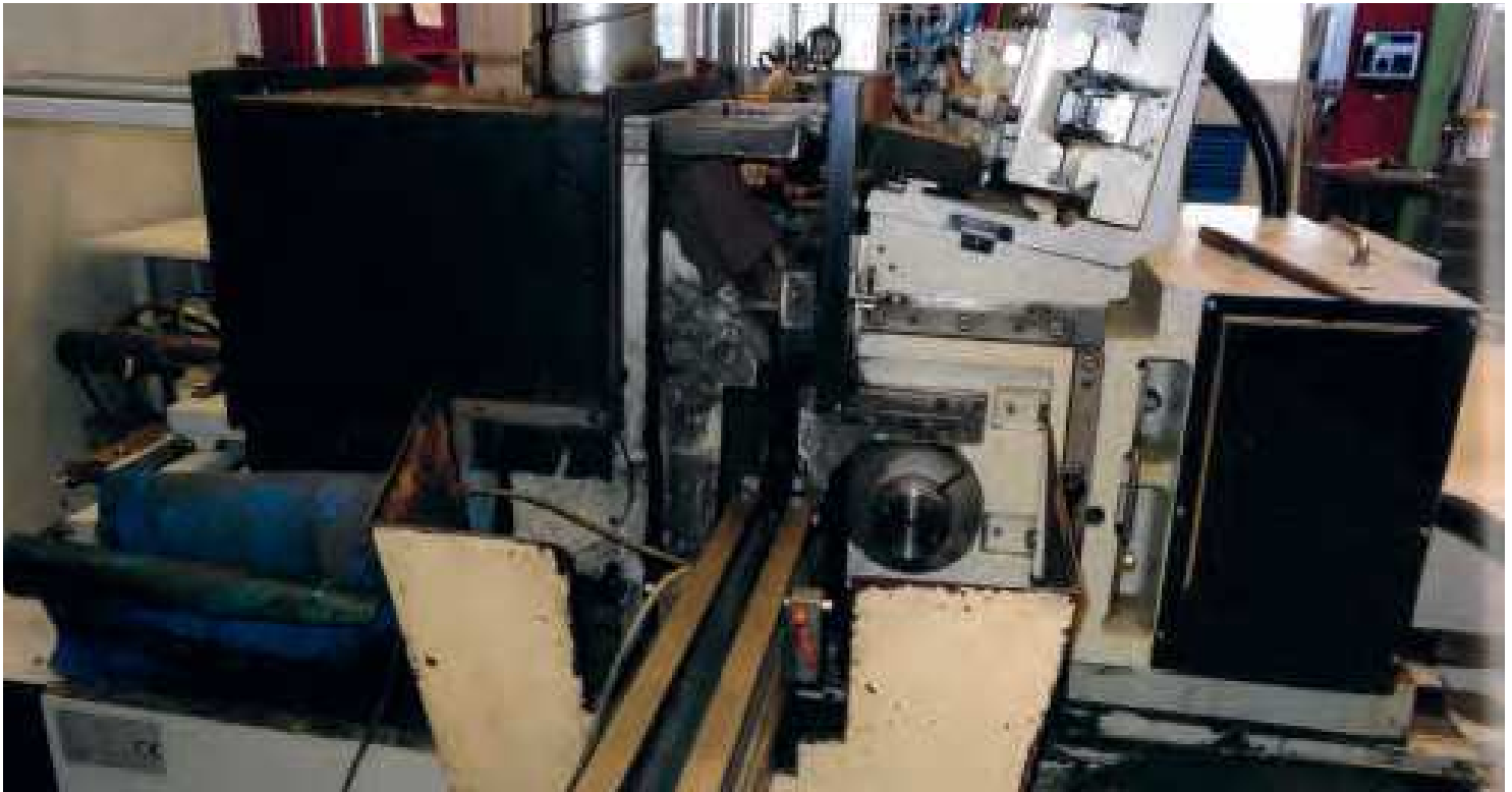
Bild 3: Die Mikrosa SASL 125 vor dem Retrofit. Die Schäden sind unübersehbar.
