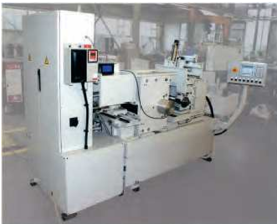
Bild 4: Die Spitzenlos-Schleifmaschine Mikrosa SASL 125 nach dem Retrofit (Bilder: Huttelmaier GmbH, Schorndorf)
